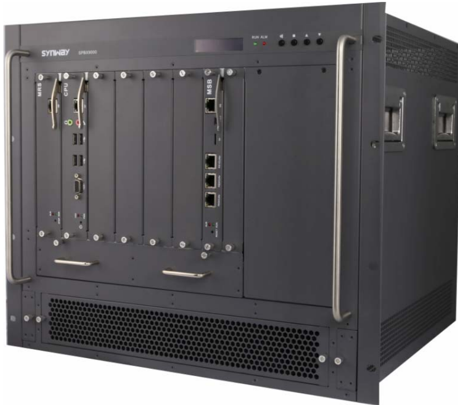
图 3-10 SPBX9000 系列交换机机箱外型图
