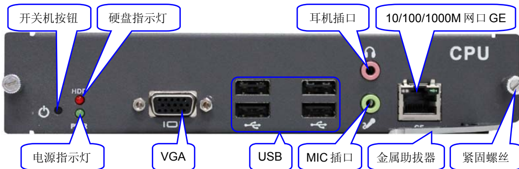
图 4-34 CPU 系列主控板面板图
