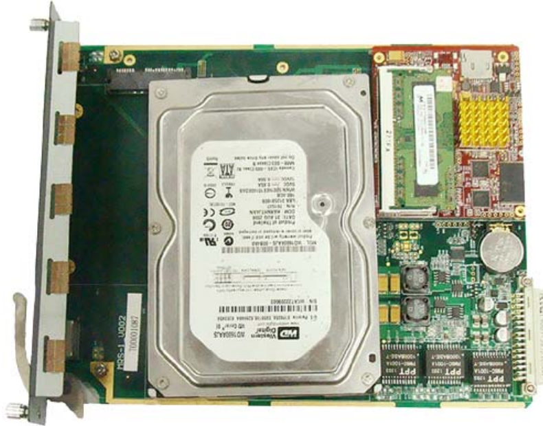
图 4-28 安装一块 3.5 寸硬盘的 MRS01 板卡
