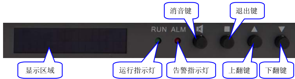
图 3-12 SPBX9000 系列交换机监控区示意图
