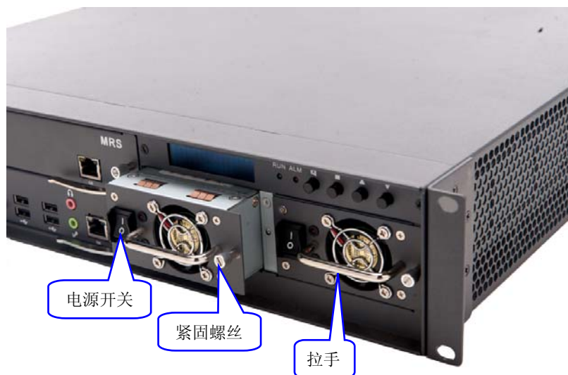
图 6-1 电源拆装示意图
