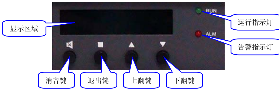
图 3-3 SPBX1000 系列交换机监控区示意图
